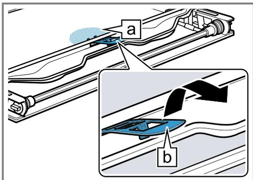
5. Die Zwischenscheibe von unten anheben **1** und in Pfeilrichtung herausnehmen **2**.
