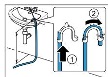
Odtokovou hadici úplně prostrčte kolenem → Strana 12 a upevněte ji pomocí spojovacího materiálu. Koleno upevněte ve výšce maximálně 100 cm.
