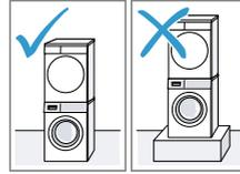
Ovaj uređaj postavite u stub sa mašinom za pranje i za sušenje veša samo sa setom za povezivanje proizvođača mašine za sušenje veša.
