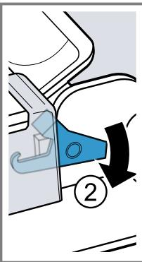
Die Sperrhebel sind zugeklappt. Die Gerätetür ist gesichert und kann nicht ausgehängt werden.
