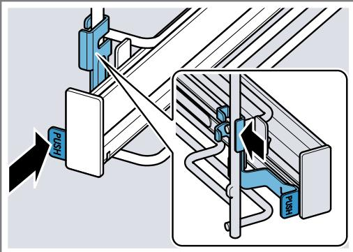
2. **PUSH** gedrückt halten ① und die Schiene nach außen schwenken ②, bis die vordere Halterung ③ ausgehängt ist.
