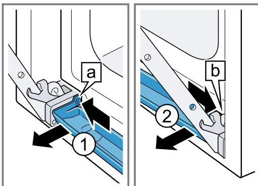
3. Die Kondensatwanne leicht nach vorne kippen bis sich die unteren Haltehaken lösen.
