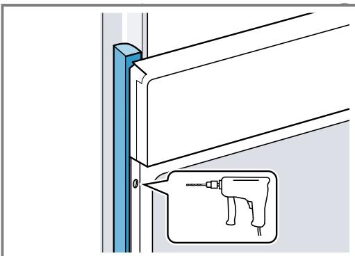
3. Gerät mit adäquater Schraube befestigen.
