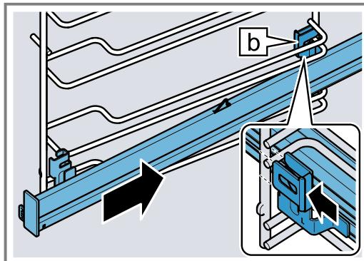
3. **PUSH** gedrückt halten ① und die Auszugsschiene nach innen schwenken ②, bis die Halterung ③ in den unteren Stab einhängt ist.
