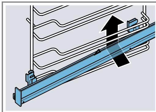
2. Die Schiene längs zu den Führungsstäben nach hinten führen und beide Halterungen jeweils auf den unteren Stab aufschieben. Dabei mit der hinteren Halterung ③ den senkrechten Stab umgreifen.
