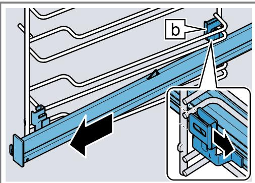
4. Die Auszugsschiene entfernen.
