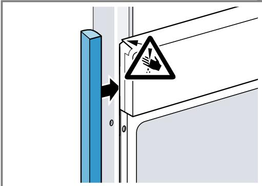
2. Aluprofile vorbohren, um eine Schraubverbindung herzustellen.
