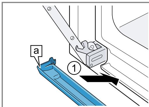
2. Die Haken **a** der Kondensatwanne links und rechts in die Spalte einrasten ①.
