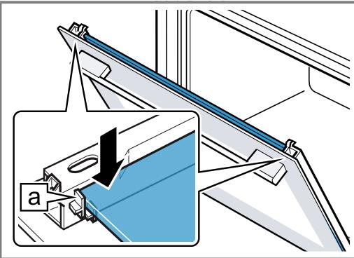
5. Die Gerätetür öffnen und Türdichtung einhängen.
