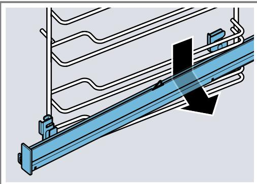
5. Die Auszugsschiene reinigen.
