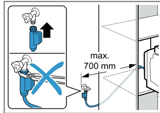
Kunststoff-Überwurfmutter nur von Hand festziehen. Zulaufschlauch nicht auf Zug belasten, einklemmen, quetschen, oder zu eng biegen.
