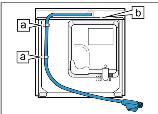
5. Zulaufschlauch mit Anschlusswinkel am Hausanschluss montieren.
