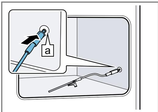
5. Das Röhrchen am Ende des Anschlussschlauches in den Behälter stellen. Bei Bedarf das Röhrchen mit dem Klipp **a** am Behälter befestigen.
