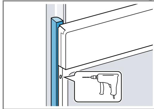
4. Das Gerät mit adäquater Schraube befestigen.
