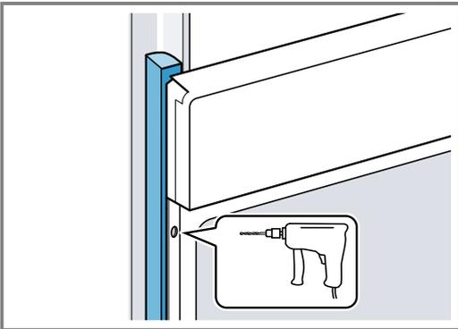
4. Das Gerät mit adäquater Schraube befestigen.
