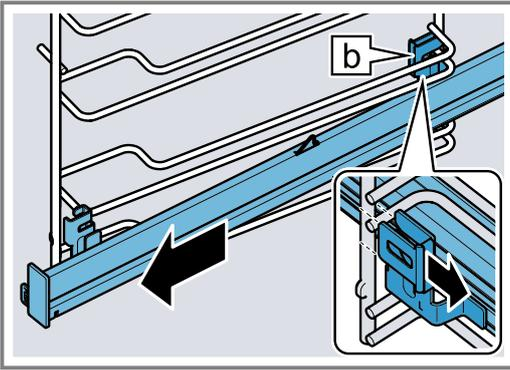
4. Die Auszugsschiene entfernen.
