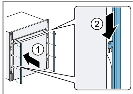
11. Die Blenden links und rechts auf Höhe der Befestigungselemente andrücken, bis ein Klickgeräusch ertönt.
