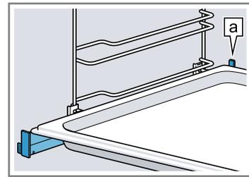
**Hinweis:** Vollständig herausgezogen rasten die Auszugsschienen ein. Die Auszugsschienen mit etwas Druck zurück in den Garraum schieben.
