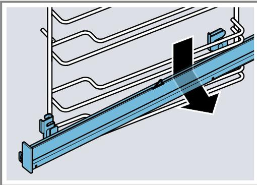
5. Die Auszugsschiene reinigen.
