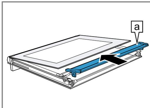
8. Die Innenscheibe mit der Halterung
