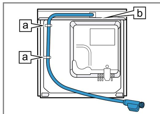
5. Zulaufschlauch mit Anschlusswinkel am Hausanschluss montieren.
