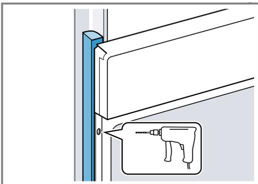
3. Gerät mit adäquater Schraube befestigen.
