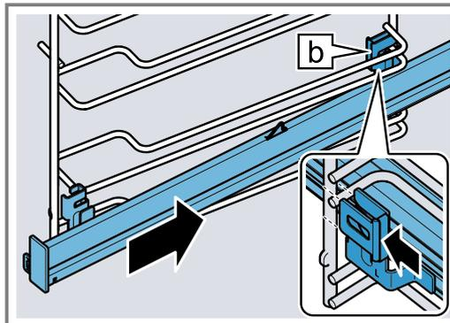
3. **PUSH** gedrückt halten **1** und die Auszugsschiene nach innen schwenken **2**, bis die Halterung **a** in den unteren Stab eingehängt ist.
