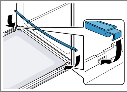
6. **Hinweis:** Achten sie beim Einschieben der Scheibe, dass die glänzende Seite der Scheibe außen ist und der Ausschnitt links und rechts oben ist. Die Innenscheibe in die linke und rechte Halterung **a** schieben.
