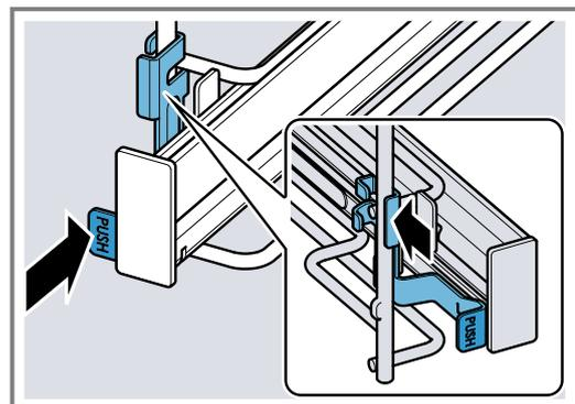
2. **PUSH** gedrückt halten ① und die Schiene nach außen schwenken ②, bis die vordere Halterung **a** eingehängt ist.
