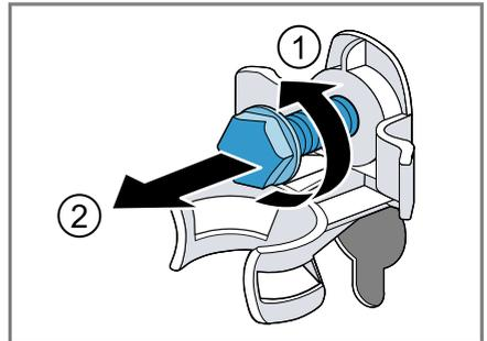
3. Síťový kabel odstraňte z držáku.
