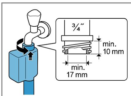
2. Opatrně otevřete přívod vody a zkontrolujte těsnost připojovacích míst.
