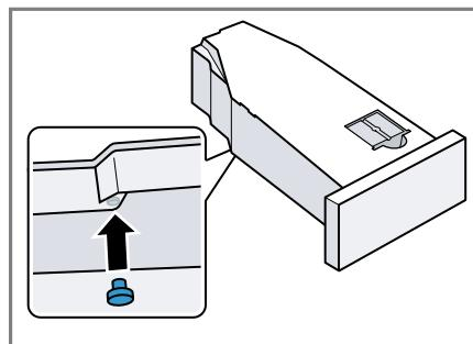
3. Očistite filter u posudi za kondenzat.
