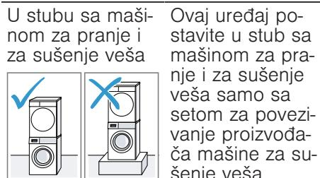
Ovaj uređaj postavite u stub sa mašinom za pranje i za sušenje veša samo sa setom za povezivanje proizvođača maštine za sušenje veša.
