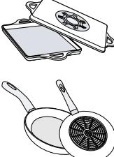
Dna posuda za kuvanje sa komponentama od aluminijuma.                                                                   | Takva dna posuda za kuvanje smanjuju feromagnetsnu površinu usled čega se posudu za kuvanje predaje manja snaga. Može se desiti da ove posude ne budu dovoljno ili uopšte prepoznate, zbog čega se nedovoljno zagrevaju. |
