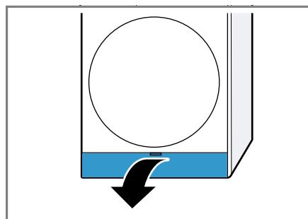
Ako stavite krpnu ispod klapne za održavanje, možete da sakupite preostalu vodu iz jedinice na dnu.
