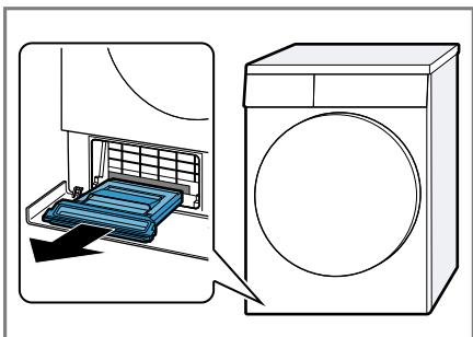
U rezervoaru za vlakna može da se nalazi kondenzat i da isuri tokom izvlačenja.
