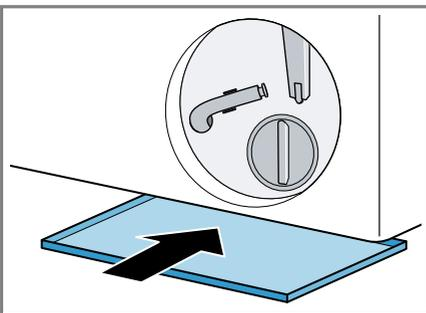
6. Den Entleerungsschlauch aus der Halterung nehmen.
