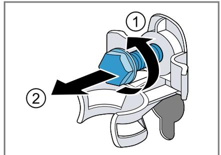
3. Die Netzanschlussleitung von der Halterung entfernen.
