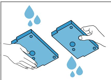
Tvrđokornu nečistoću možete oprezno da očistite usisivačem. Filtersku podlošku nemojte čistiti sredstvima za čišćenje.
