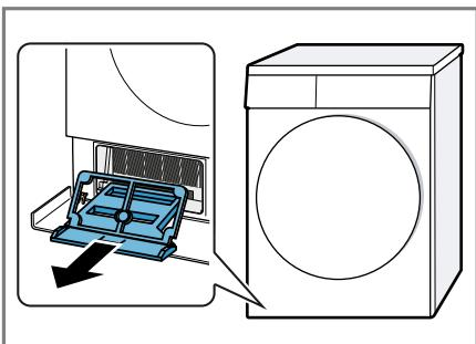
7. Rešetku ulaza za vazduh oprezno očistite nastavkom sa četkom za usisivač.
