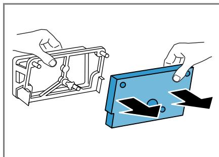
Vodite računa da ne deformišete ili oštetite filtersku podlošku.
