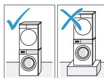
Ovaj uređaj po- stavite u stub sa mašinom za pra- ne i za sušenje veša samo sa setom za povezivanje proizvođa- ča maštine za su- šenje veša.
