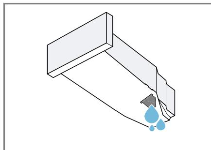
Pre rada uređaja se uverite se da ste ubacili posudu za kondenzat.
