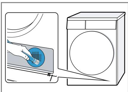
5. Umetak očistite mlazom vode i ostavite da se osuši.
