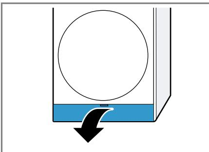
Ako stavite krpu ispod klapne za održavanje, možete da sakupite preostalu vodu iz jedinice na dnu.
