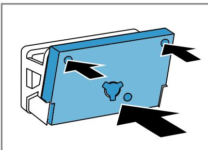
Vodite računa da ne deformišete ili oštetite očišćenu filtersku podlošku ili da je ne postavite na nosače sa pogrešne strane.
