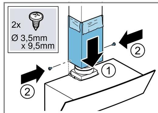
Para evitar arañazos, colocar papel a modo de protección sobre los bordes del revestimiento inferior de la chimenea.
