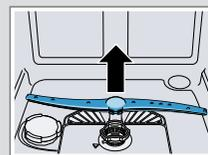
3. Proverite da li na izlaznim mlaznicama prskalica ima začepljenja tako što ćete ih postaviti pod mlaz tekuće vode i po potrebi uklonite strana tela.
