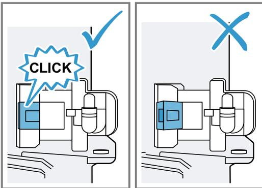
7. Insérez le filtre à graisse.
