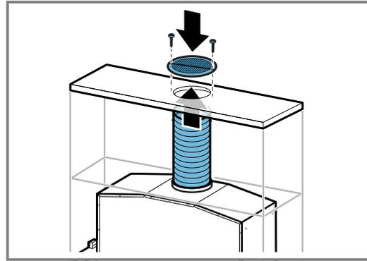
3. Avvitare saldamente la griglia in direzione del mobile da incasso.
