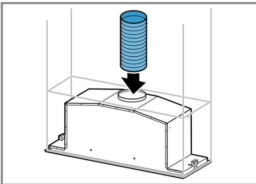
2. Realizzare il collegamento all'apertura per lo scarico dell'aria.
