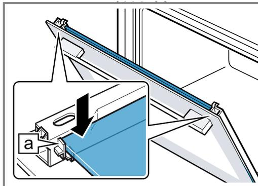
5. Die Gerätetür öffnen und Türdichtung einhängen.
