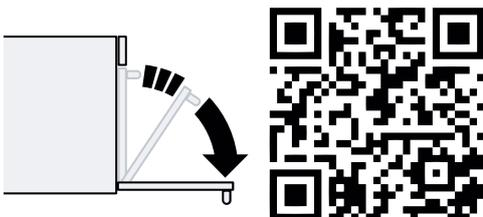
1. Die Gerätetür etwas öffnen und die roten dreieckigen Transportsicherungen nach außen ziehen.
