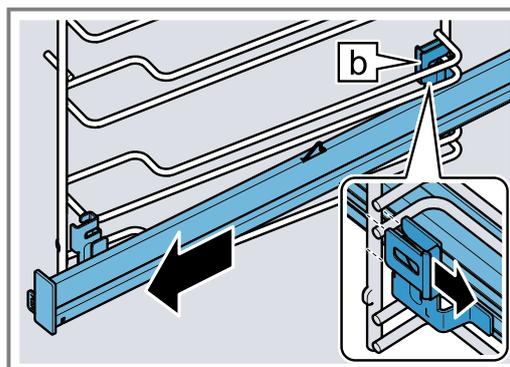
4. Die Auszugsschiene entfernen.
