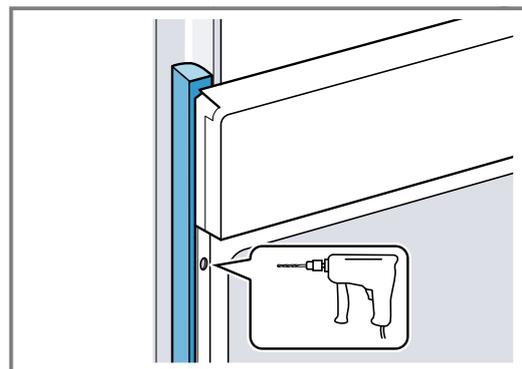
3. Gerät mit adäquater Schraube befestigen.
