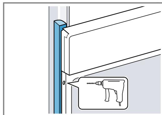
3. Gerät mit adäquater Schraube befestigen.
