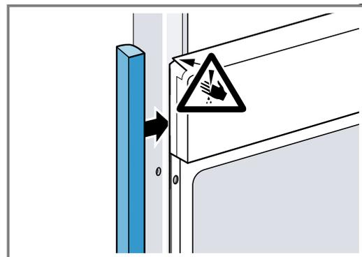
2. Aluprofile vorbohren, um eine Schraubverbindung herzustellen.
