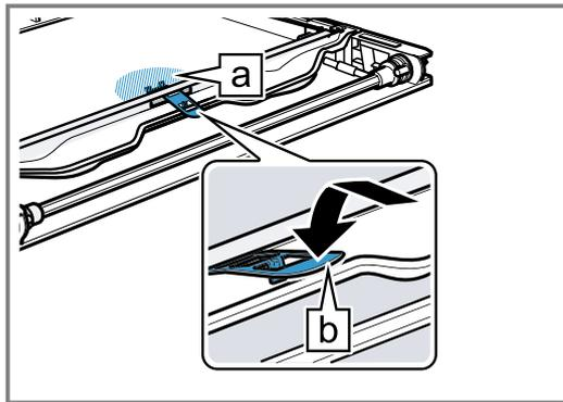
3. Die Innenscheibe an der Gerätetür mittig ausrichten.
