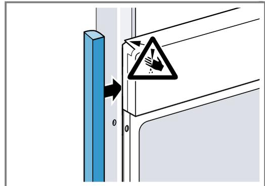
2. Aluprofile vorbohren, um eine Schraubverbindung herzustellen.
