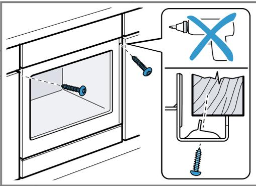
8. Die Gerätetür etwas öffnen, die Blenden anlegen und zuerst oben, dann unten festschrauben.
