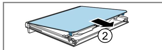
4. Die Zwischenscheibe im Bereich [a] nach unten drücken und die Halterung [b] vorsichtig anheben, bis sie sich herausziehen lässt.
