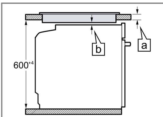
**29.3 Einbau unter einer Arbeitsplatte**
