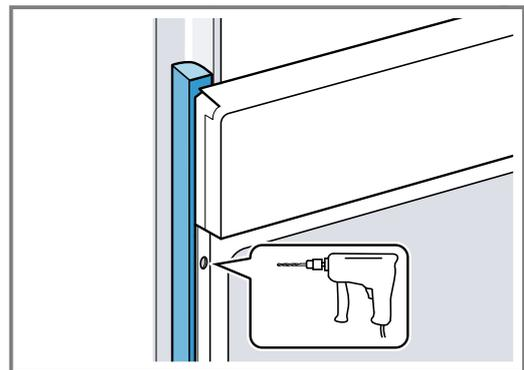
3. Gerät mit adäquater Schraube befestigen.
