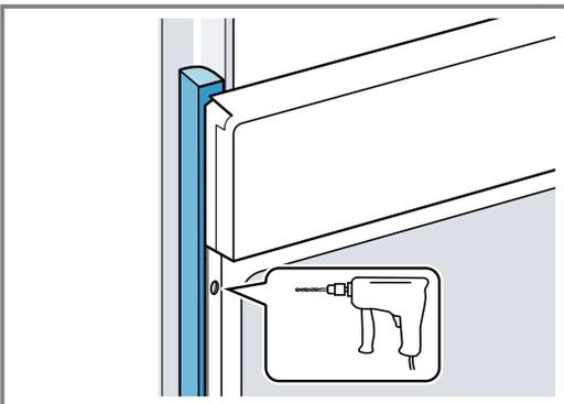
4. Das Gerät mit adäquater Schraube befestigen.
