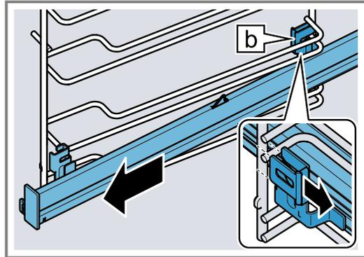
4. Die Auszugsschiene entfernen.
