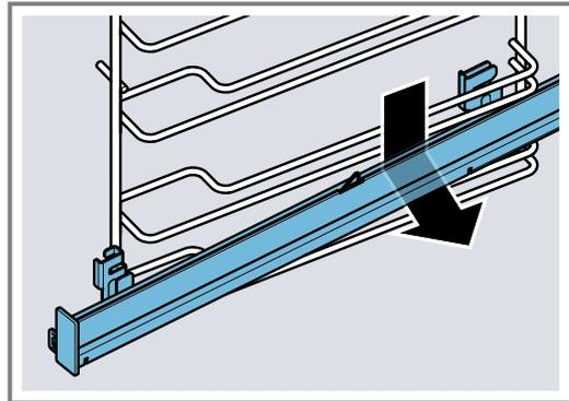
5. Die Auszugsschiene reinigen.
