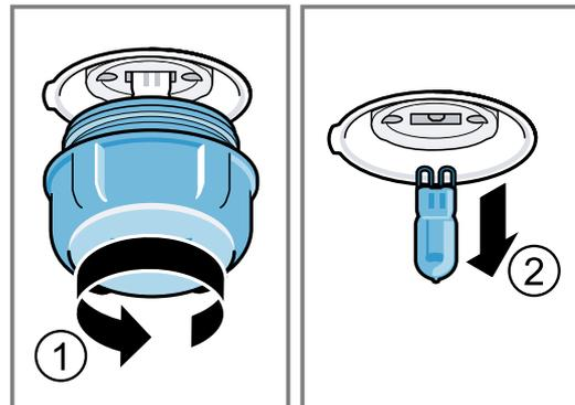
4. Die neue Halogenlampe einsetzen und fest in die Fassung drücken. Auf die Stellung der Stifte achten.
