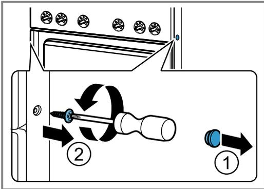
7. **Hinweis:** Die unten erwähnten Schrauben entfernen, damit die Schalter und die Elektronikteile nicht beschädigt werden.
