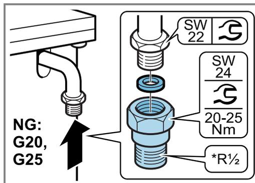
3. Das Anschluss-Stück mit einem **24er Schlüssel festhalten** und den Gewindeanschluss des Gasrohrs oder des Sicherheitsgasschlauchs mit einem 24er Schlüssel am Anschluss-Stück aufsetzen und fest anziehen.
