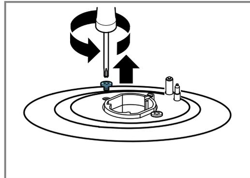
4. Die zwei Schrauben (T20) vorne rechts und links an der Kochfeldplatte entfernen. Die Kunststoffteile nicht herausnehmen, die sich darunter befinden.
