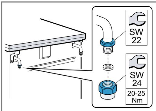
3. Nach der Änderung der Anschlussseite eine Dichtungsprüfung durchführen. Weitere Informationen erhalten Sie in Kapitel "Dichtheits- und Funktionsprüfung" → Seite 51.
