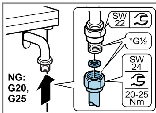
5. Die Schließvorrichtung für den Gasanschluss öffnen. Dichtungsprüfung → Seite 51 vornehmen.
