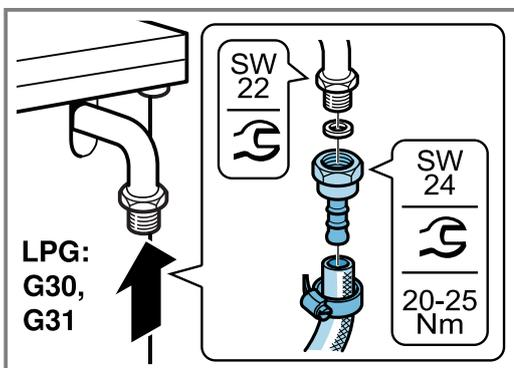
3. Den Sicherheitsgasschlauch aufstecken und ihn mit einer Schraubverbindung oder einer Klemmschelle gut festziehen.
