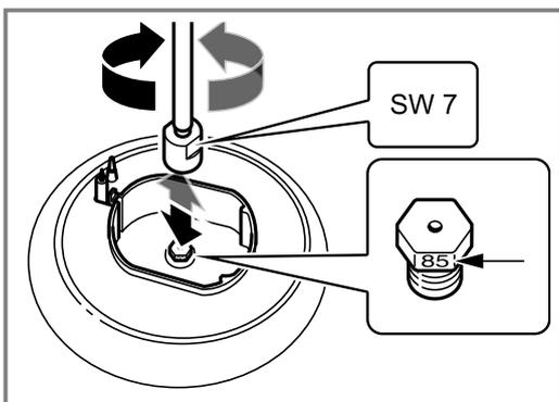
5. Wenn Ihr Gerät über einen Wokbrenner mit seitlichem Zugang verfügt, die Brennerdüse demontieren, wie unten abgebildet.
