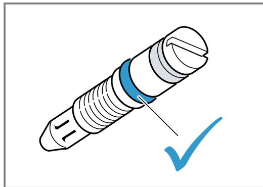
4. Die neuen Bypass-Düsen einsetzen und gut festziehen. Sicherstellen, dass alle Bypass-Düsen an den richtigen Hähnen befestigt sind.
