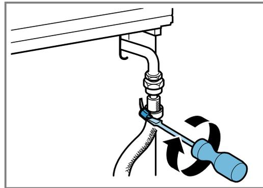
4. Die Schließvorrichtung für den Gasanschluss öffnen. Dichtheitsprüfung → Seite 51 vornehmen.
