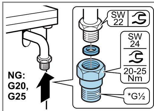
3. Die neue Dichtung in das Gasrohr oder den Sicherheitsgasschlauch setzen. Auf den korrekten Sitz der Dichtung achten.
