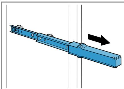
2. Desplazar el bloqueo en la dirección que marca la flecha ① y soltarlo del perno ②.
