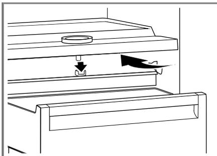
3. Colocar la placa de cristal en la placa separadora.
