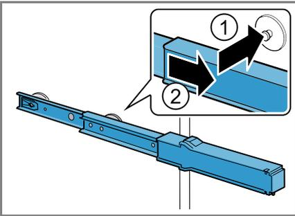
2. Montar el carril telescópico en el perno posterior ① y desplazar el bloqueo hacia atrás ②.
