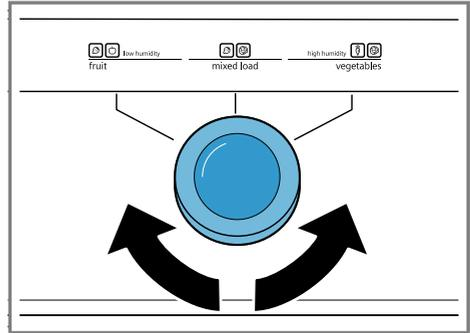
Girar el regulador de humedad para ajustar la humedad del aire en el cajón para fruta y verdura en función de la naturaleza y la cantidad de alimentos que se vayan a guardar en el mismo:
