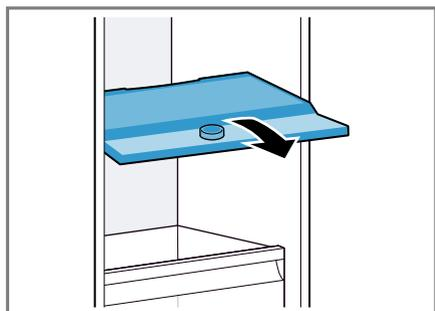
4. Levantar la placa separadora y extraerla por uno de sus laterales.
