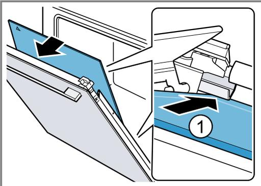
2. **Nota:** El cristal intermedio se coloca automáticamente mediante el movimiento giratorio del espaciador.
