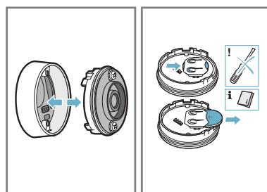
3. Insérer une nouvelle pile en observant les instructions relatives aux pôles de la pile. Utiliser uniquement des piles de qualité de type CR2032.
