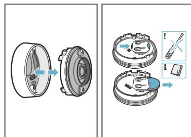
3. Colocar la nueva batería siguiendo las instrucciones de polaridad de la batería. Utilizar solo baterías de tipo CR2032 de buena calidad.
