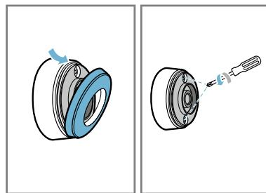
2. Ouvrir le couvercle du capteur de cuisson et retirer la pile du socle.
