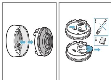
3. Colocar la nueva batería siguiendo las instrucciones de polaridad de la batería. Utilizar solo baterías de tipo CR2032 de buena calidad.
