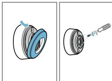
2. Abrir la tapa del sensor de cocción y retirar la batería del interior de la base.
