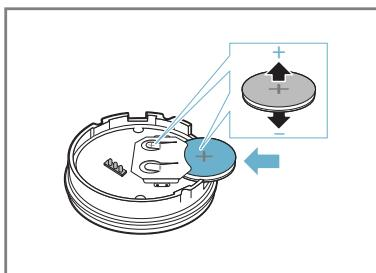
**Remarque :** N'utiliser aucun objet métallique pour retirer la pile. Ne pas toucher les bornes de la pile.
