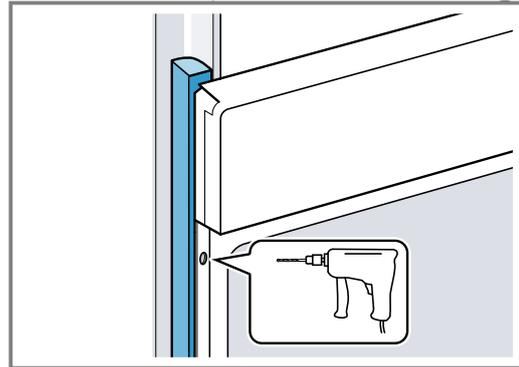
3. Gerät mit adäquater Schraube befestigen.
