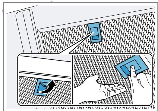
2. Retirar los filtros antigrasa de las sujeciones. Sujetar los filtros antigrasa en posición horizontal para evitar que la grasa gotee.
