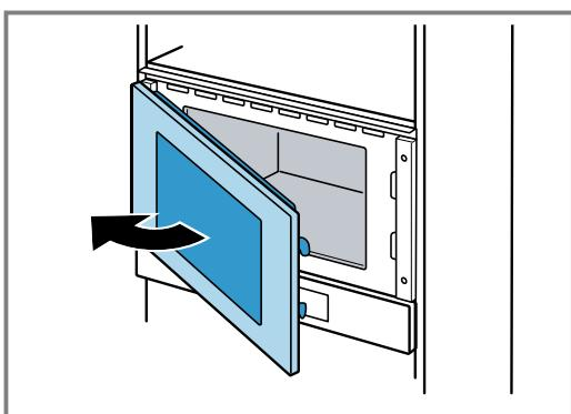
4. Aparafusar o aparelho ao móvel do lado oposto das dobradiças.
