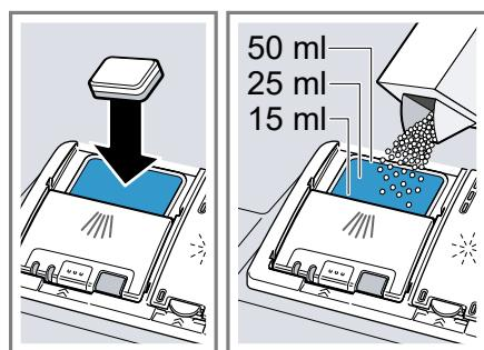
Wenn Sie Tabs verwenden, genügt eine Tablette. Tabs quer einlegen. Wenn Sie Pulverreiniger oder Flüssigreiniger verwenden, beachten Sie die Dosierungshinweise des Herstellers und die Dosierungsteilung der Reinigerkammer. Bei normaler Verschmutzung genügen 20 ml – 25 ml Reiniger. Bei wenig verschmutztem Geschirr genügt eine etwas geringere als die angegebene Reinermenge.
