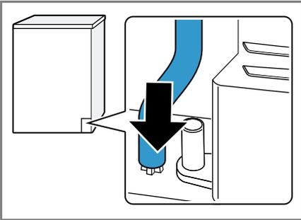
3. Insertar la manguera de desagüe hasta el tope en la boquilla.
