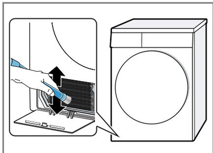
Asegurarse de aspirar las láminas de arriba hacia abajo para que no se deformen o se dañen.
