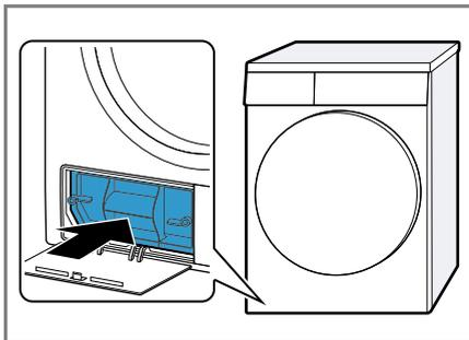
2. Cerrar los tiradores de la cubierta del intercambiador de calor.
