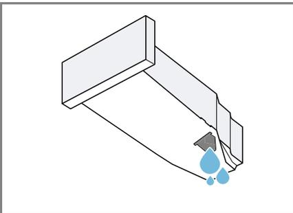
Asegurarse de insertar el recipiente de agua condensada antes de la puesta en marcha del aparato.
