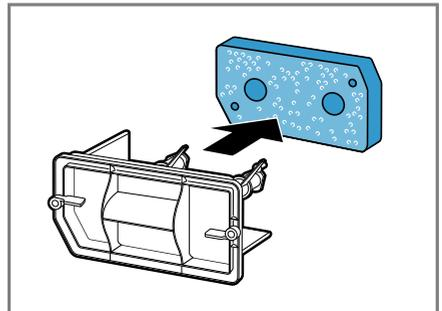
Asegurarse de no deformar o dañar la manta filtro.
