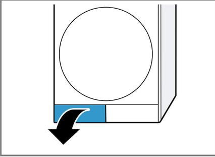
Si se coloca un paño debajo de la trampilla de mantenimiento, se puede recoger el agua residual de la unidad de la base.
