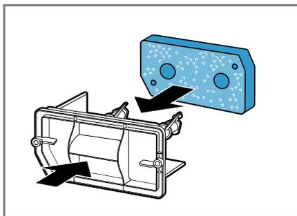
Asegurarse de no deformar, dañar o colocar al revés la manta filtro limpia al introducirla en las sujeciones.
