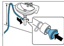
Asegurar el punto de conexión con una abrazadera (12-22 mm). Fijar la manguera de salida de agua con un tubo guía de una
