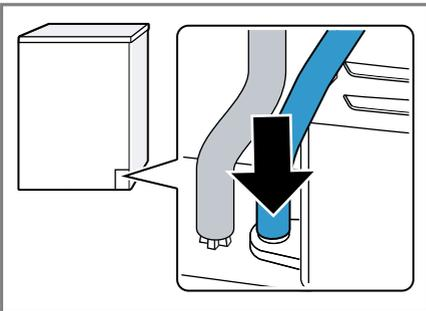
4. Colocar la manguera de desagüe en la guía de la manguera.
