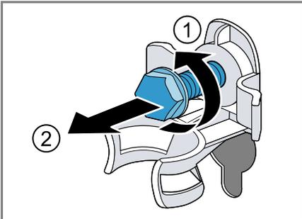
3. Die Netzanschlussleitung aus der Halterung ziehen.
