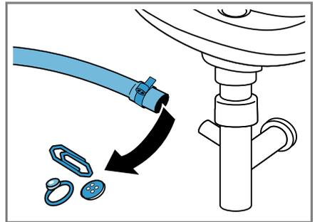
5. Den Wasserablaufschauch aufstecken und die Anschlussstelle mit der Schlauchschelle sichern.
