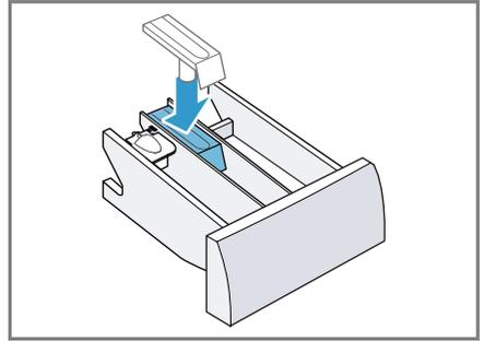
6. Die Öffnung für die Waschmittelschublade reinigen.
