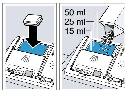
Wenn Sie Tabs verwenden, genügt eine Tablette. Tabs quer einlegen. Wenn Sie Pulverreiniger oder Flüssigreiniger verwenden, beachten Sie die Dosierungshinweise des Herstellers und die Dosierungsteilung der Reinigerkammer. Bei normaler Verschmutzung genügen 20 ml – 25 ml Reiniger. Bei wenig verschmutztem Geschirr genügt eine etwas geringere als die angegebene Reinigermenge.
