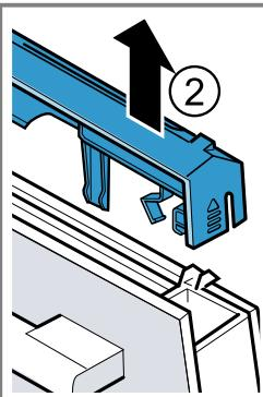
6. Izvucite unutrašnje staklo i pažljivo ga spustite na ravnu površinu.
