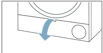
3. Hebel der Wärmetauscher-Abdeckung entriegeln.
