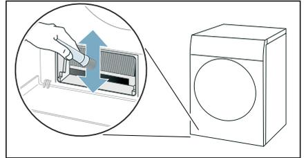
**Hinweis:** Achten Sie darauf, die Lamellen des Wärmetauschers von oben nach unten zu reinigen und nicht zu verbiegen oder zu beschädigen.
