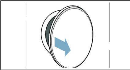
2. Feuchtigkeitssensor mit angerauhtem Schwamm reinigen.
