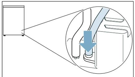
6. Ablaufschlauch in die Schlauchführung des Geräts drücken.
