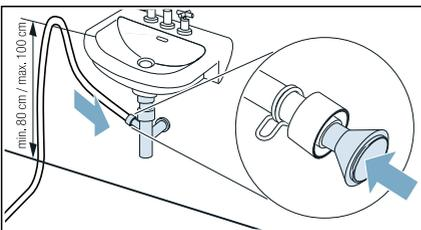
Anschluss-Stelle muss mit Schlauchschelle gesichert werden (Spannbe-
