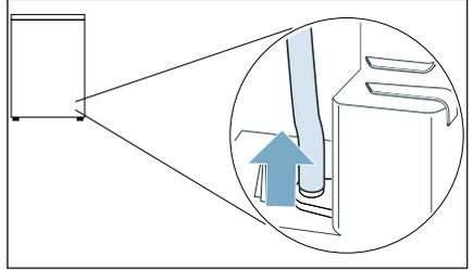
**Hinweis:** Beim Auslieferungszustand des Geräts ist der Kondenswasser-Schlauch auf dem Stutzen befestigt.
