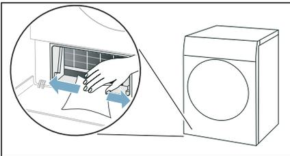
**Hinweis:** Achten Sie darauf, den freiliegenden Wärmetauscher nicht zu beschädigen.
