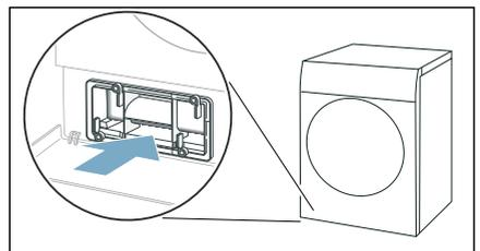
**Hinweis:** Sie können die Wärmetauscher-Abdeckung nur einschieben, wenn sich der Einsatz im Gerät befindet.
