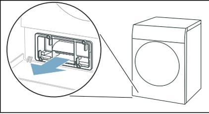
5. Filtermatte vorsichtig von der Wärmetauscher-Abdeckung ziehen.
