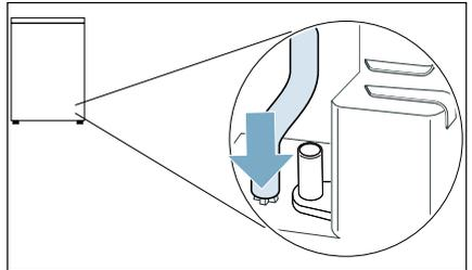
5. Ablaufschlauch aus dem Zubehör nehmen und bis zum Anschlag auf den freiliegenden Stutzen schieben.
