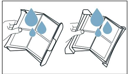
8. Flusensiebe abtrocknen, zuklappen und wieder einsetzen.
