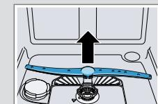
3. Pod tekoucí vodou zkonzolujte, zda nejsou ucpané výstupní trysky ostříkovacích ramen a popř. odstraňte cizí tělesa.
