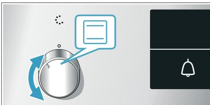
2. Seleccionar la temperatura o el nivel del grill con el mando de temperatura.
