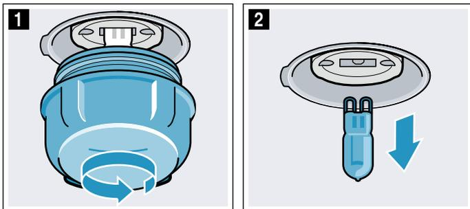
4. Volver a atornillar el cristal protector. En función del tipo de aparato, el cristal protector estará equipado con una junta tórica. Volver a encastrar la junta tórica antes de atornillar el cristal protector.
