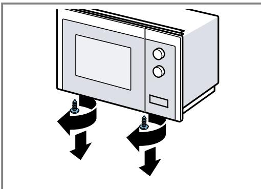
5. Upevnite zabudovaný rám na dne mikrovlnnej rúry pomocou oboch vonkajších skrutiek.
