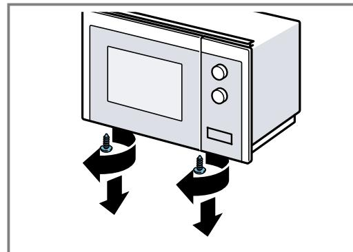
**5. Oběma vnějšími šrouby upevněte vestavný rám ke dnu mikrovlnné trouby.**
