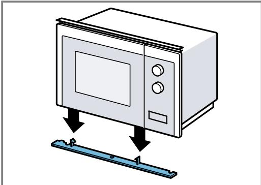
3. Atornillar el tornillo central de la base del microondas.
