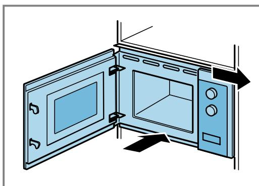
**3. Cihaz ortalanana kadar cihazın vidalarını sıkınız.**
