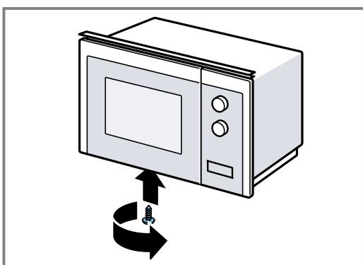
4. Soltar los dos tornillos exteriores de la base del microondas.
