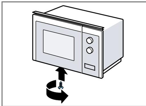
4. Solte os 2 parafusos exteriores no fundo do micro-ondas.
