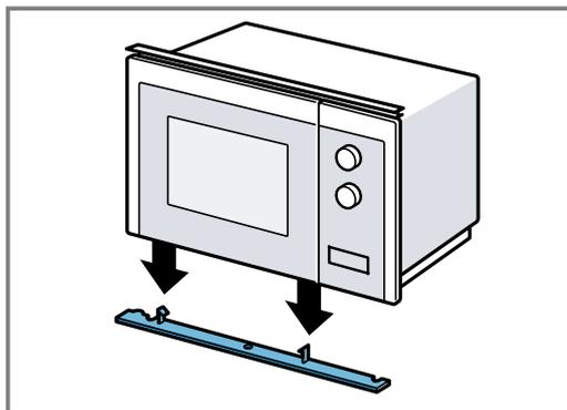
3. Aperte o parafuso central no fundo do micro-ondas.
