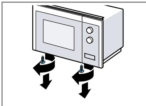
5. Fixe o aro para embutir no fundo do micro-ondas com os dois parafusos exteriores.
