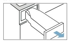
8. Rode o recipiente de água de condensação 180° na parte inferior e remova o tampão colocado.
