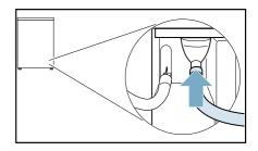
Fixe o outro lado da mangueira de drenagem, conforme a situação de ligação, com o acessório restante. Layatório:
