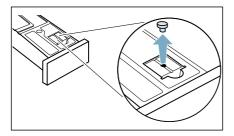
Rode a parte inferior do reservatório da água de condensação 180° e coloque o tampão.
