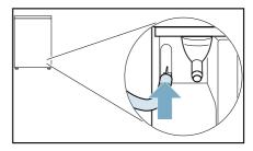
5. Retire a mangueira de escoamento do acessório, fixe-a ao bocal colocado a descoberto e insira-a até ao batente.
