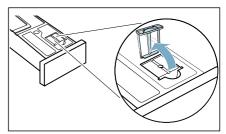
Remova o tampão colocado no rebaixo do recipiente de água de condensação.
