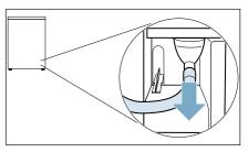
Conselho: Quando o aparelho é fornecido, a manqueira de água de condensação está fixada no bocal.
