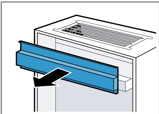
2. De geurfilter verwijderen.
