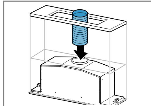
**2.** De verbinding met de afvoerluchtopening maken.
