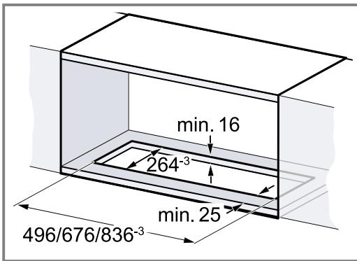
2. Réaliser la découpe pour le conduit d'évacuation d'air soit au-dessus du meuble d'encastrement, soit derrière le meuble d'encastrement.
