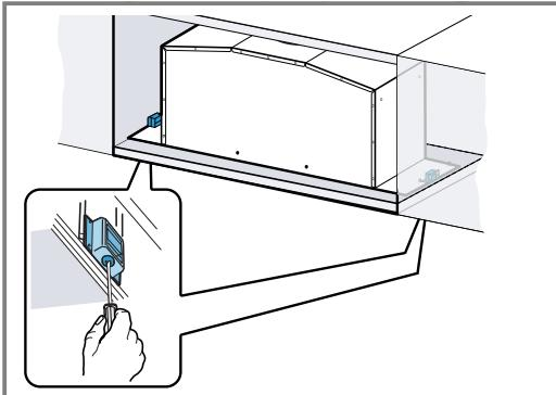
**3.** Het frame aanbrengen en van onderaf vastschroeven aan het apparaat.
