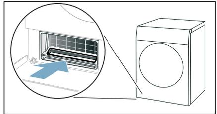
11. Wärmetauscher-Abdeckung am Griff einschieben.
