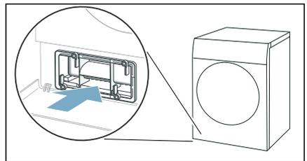
**Hinweis:** Sie können die Wärmetauscher-Abdeckung nur einschieben, wenn sich das Flusendepot im Gerät befindet.
