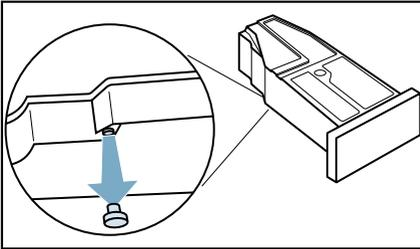
9. Kondenswasser-Behälter wieder um 180° drehen und den Stöpsel in die Vertiefung an der Oberseite des Kondenswasser-Behälters setzen.
