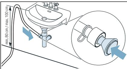
Anschluss-Stelle muss mit Schlauchschelle gesichert werden (Spannereich 12-22 mm, Fachhandel). Bei Anschluss an einen Siphon ist zu beachten, dass der Ablaufschlauch über eine Höhe von min. 80 cm, jedoch max. 100 cm geführt wird.
