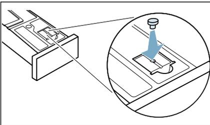
10. Den Kondenswasser-Behälter bis zum Einrasten einschieben.
