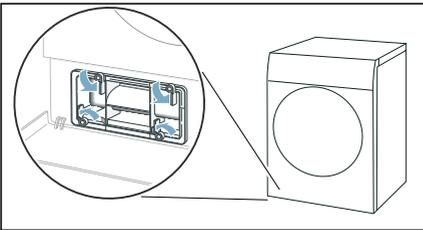
3. Wärmetauscher-Abdeckung am Griff herausziehen.
