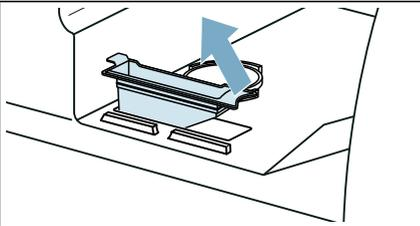
3. Das Sieb in den Wasser-Tank einsetzen.
