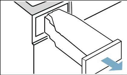
2. Das Sieb entnehmen und unter fließendem Wasser oder in der Geschirrspülmaschine reinigen.
