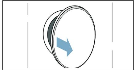
2. Feuchtigkeitssensor mit angerauhtem Schwamm reinigen.
