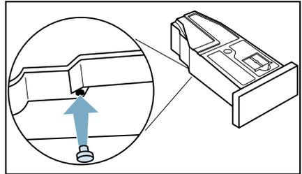
3. Sieb im Kondenswasser-Behälter reinigen. → Seite 60
