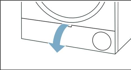
2. Hebel der Wärmetauscher-Abdeckung entriegeln.
