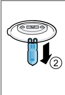
4. Die neue Halogenlampe einsetzen und fest in die Fassung drücken. Auf die Stellung der Stifte achten.
