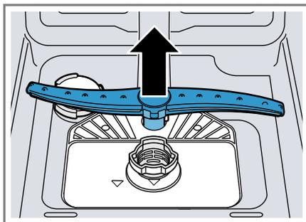
3. Comprobar si hay obstrucciones en las boquillas de salida de los brazos de aspersión bajo el chorro de agua del grifo y, en caso necesario, retirar los cuerpos extraños.
