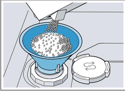
Llenar el depósito completamente con sal especial. De este modo, se desplaza y evacua el agua contenida en el depósito.
