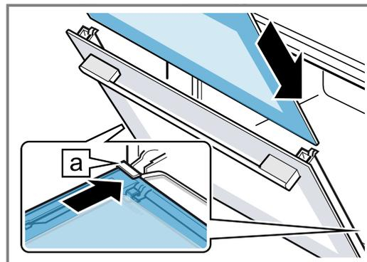
4. Presionar el cristal interior por arriba hasta que quede en la sujeción izquierda y derecha [a].
