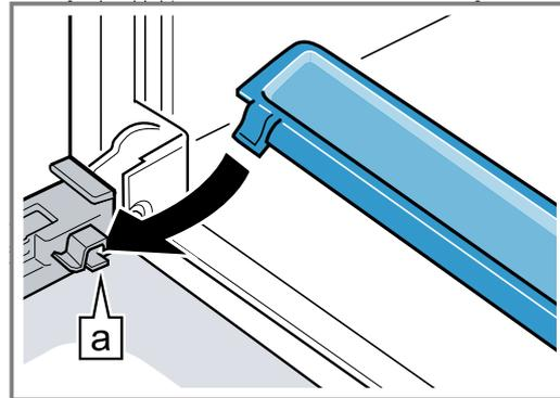
3. Desplazar el cristal interior en la sujeción izquierda y derecha [a].
