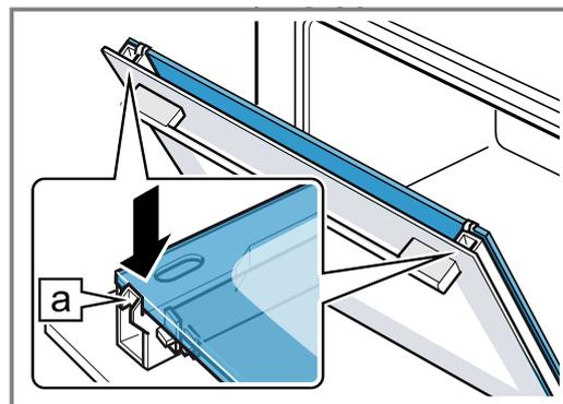
5. Colocar la cubierta de la puerta ① y presionar hasta que se oiga que ha encajado.
