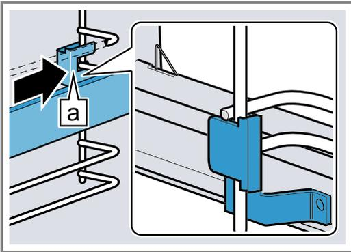
3. Mantener pulsado **PUSH** ① e inclinar el riel de extracción hacia dentro hasta que la sujeción delante [a] quede situada entre ambas guías ②.
