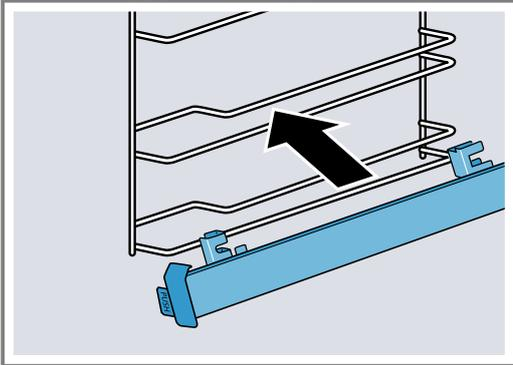
2. Introducir la sujeción [a] en la parte posterior, entre las guías inferior y superior.
