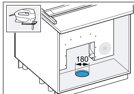
6. Kućište ventilatora gurnite u vođicu, uspostavite cevovod i pričvrstite kućište ventilatora.
