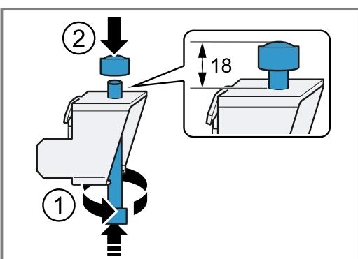
12. Uredaj iznivelište prema ploči za kuvanje ① i zategnite ga u odnosu na radnu ploču ② ③.
