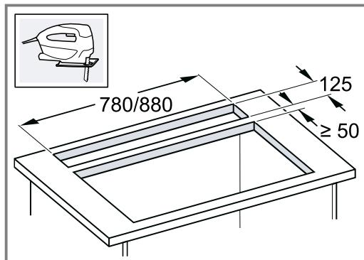
Ugao sećene površine u odnosu na radnu ploču mora da iznosi  $90^\circ$ .
