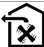
Vazduh ne sme da se odvodi u dimnjak, koji se koristi za odvodne gasove iz uređaja, koji sagorevaju gas ili druga goriva (ne važi za uređaje sa cirkulacijom vazduha).
